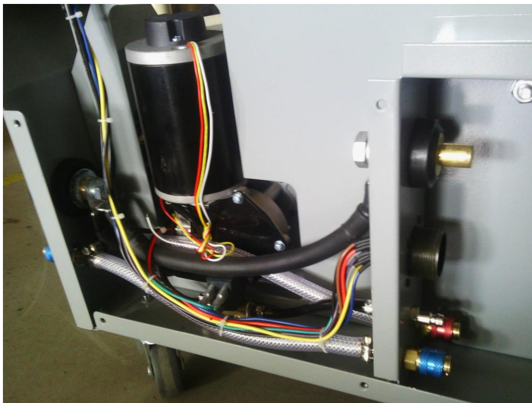
Oddelený podávač drôtu + prepojenie na kvapalinou chladený zvarací horák
